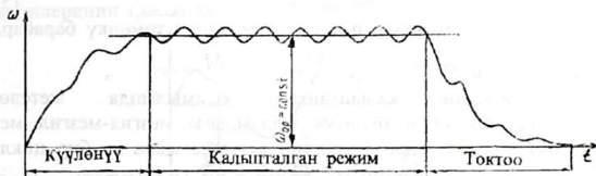
5.6-сүрөт. Машинанын толук убактысындагы, анын бурчтук ылдамдыгынын өзгөргөн диаграммасы
